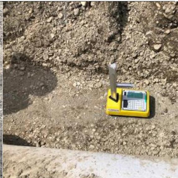
**Fotografía N° 24. Prueba de compactación con densímetro nuclear.**
